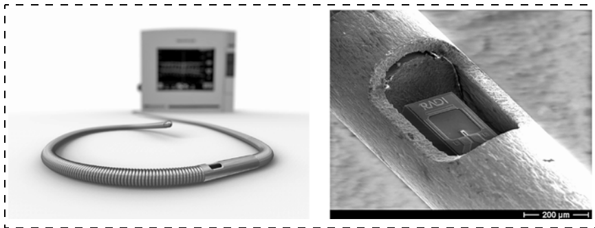
Рис. 14. Прибор Radi Pressure Wire™ и миниатюрный преобразователь давления в полости катетера [8]
