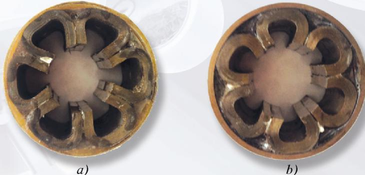
Рис. 1. Магнитопроводы из аморфного железа, созданные по предложенной технологии:
