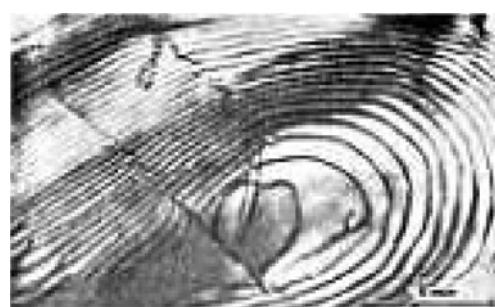
Рис. 5. Электронная фотография дислокаций, вызванных источником Франка — Рида [12, 13]
