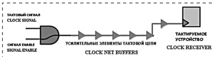
Рис. 5. Включение *clock gate*-ячейки AND в тактовую цепь
