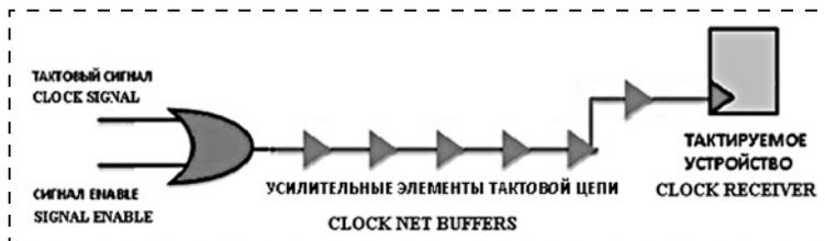
Рис. 6. Включение *clock gate*-ячейки OR в тактовую цепь
