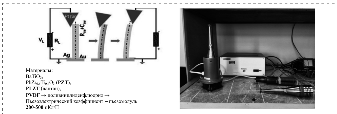
Рис. 3. Схема и устройство для пьезоэлектрического преобразования энергии на основе нитевидных кристаллов ZnO
