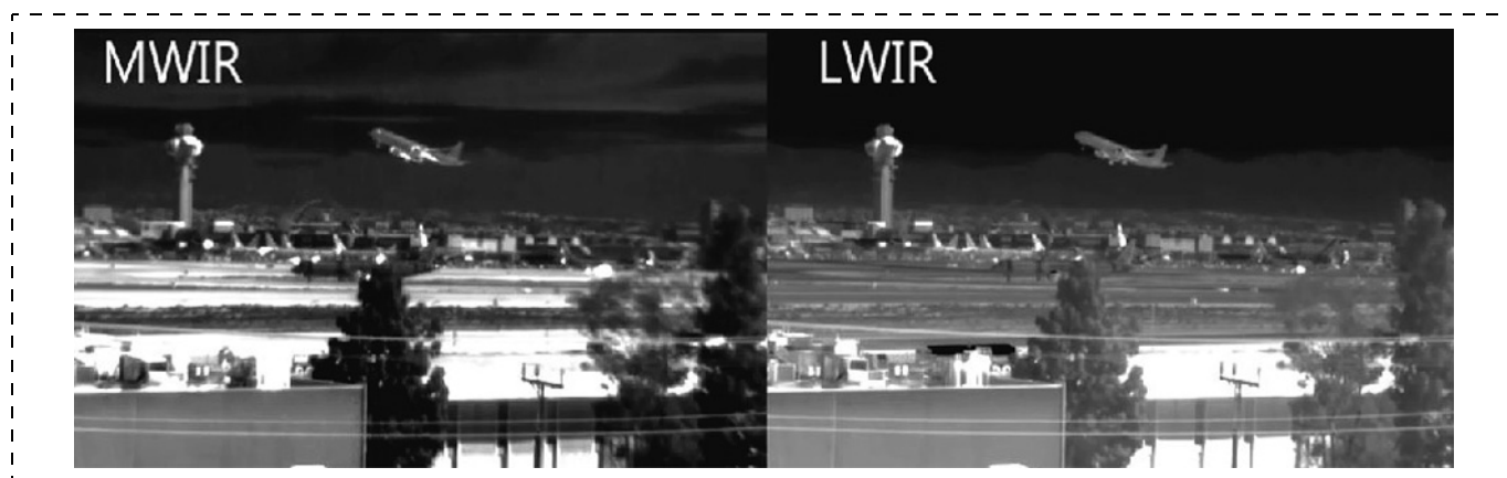
Рис. 9. Изображения, полученные в средне- и длинноволновом диапазонах с помощью МФПУ формата 1280 \times 720 с шагом 12 мкм фирмы HRL (США)
