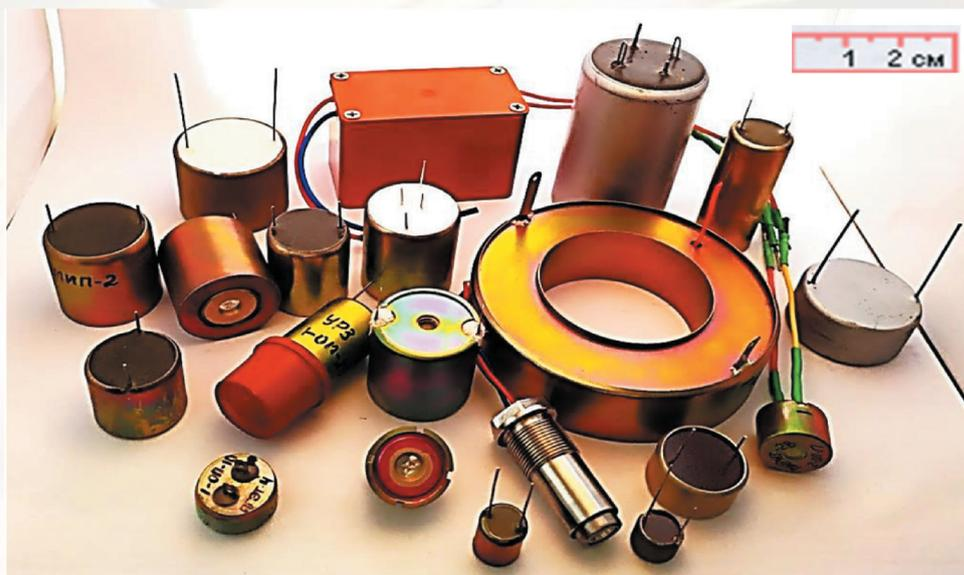
**Рис. 4. Внешний вид современных батарей ВГЭ**
