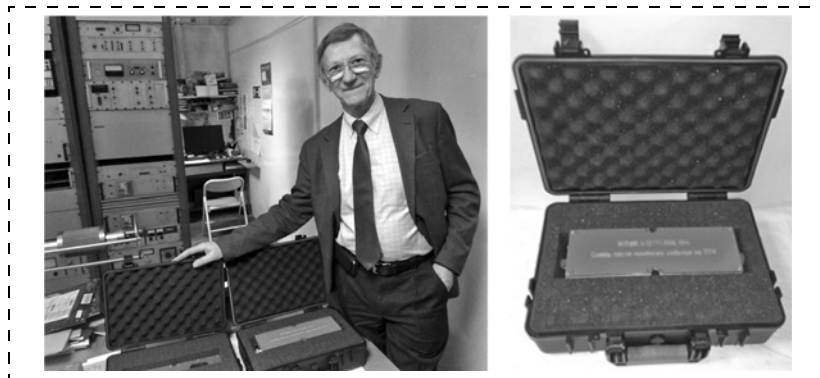
Рис. 13. Фотографии двух готовых блоков контроля КИ (а); вид блока в укладочном ящике (б)
