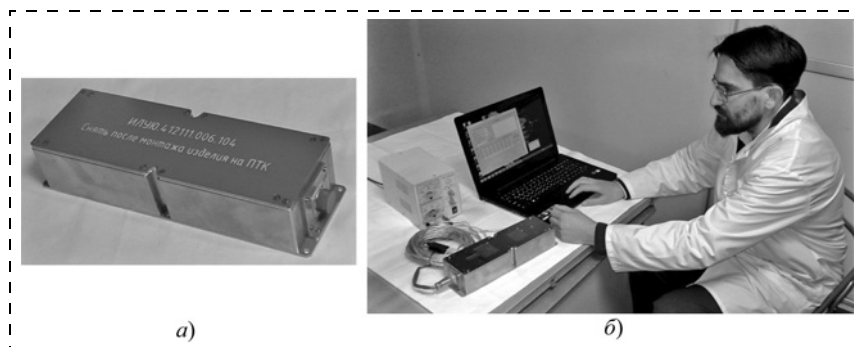
Рис. 14. Фотографии спектрометрического блока с защитной крышкой (а) и блока, подключенного к контрольной аппаратуре (б)
