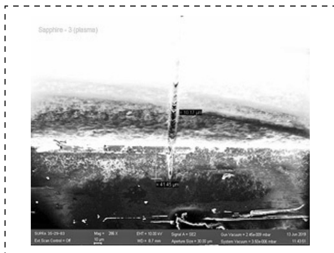
Рис. 15. Лазерное плазмохимическое воздействие на сапфир
