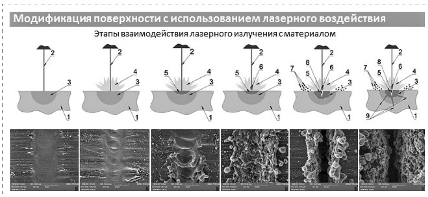
Рис. 1. Закономерности воздействия лазерного излучения на твердое тело [1]:
