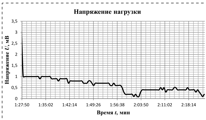
Рис. 9. Напряжение на резисторе, подключенном к ячейке из нержавеющей стали
