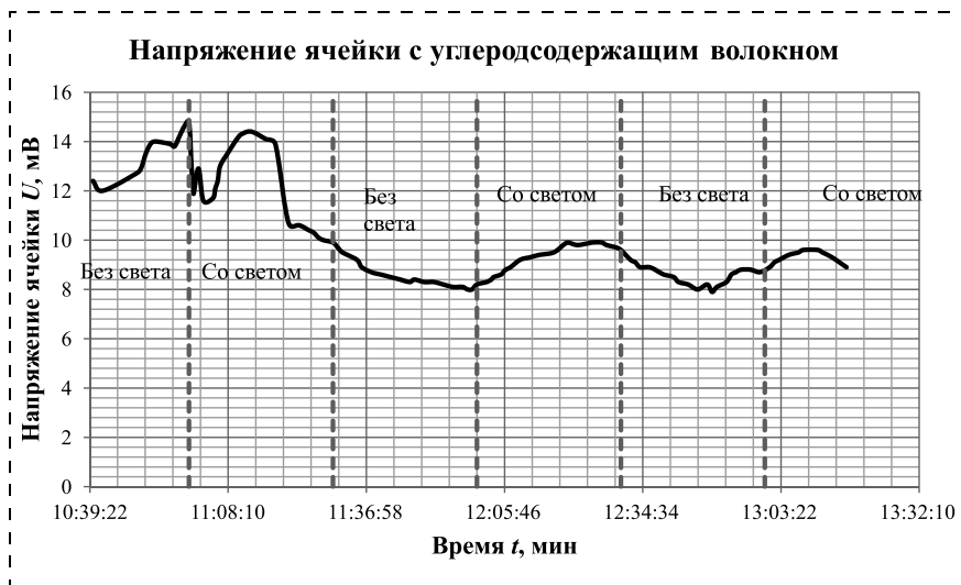
Рис. 7. Напряжение ячейки с анодом из углеродсодержащего волокна в зависимости от динамики освещения
