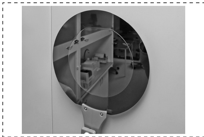
Рис. 2. Изображение пластин разного диаметра после бондинга
