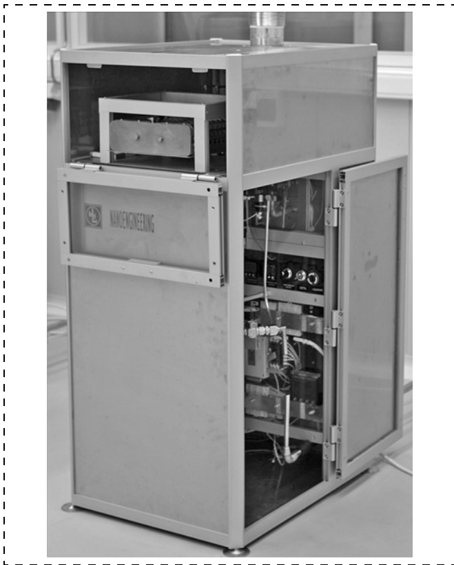
Рис. 1. Внешний вид установки Молекулярного Наслаивания "Наносерф"
